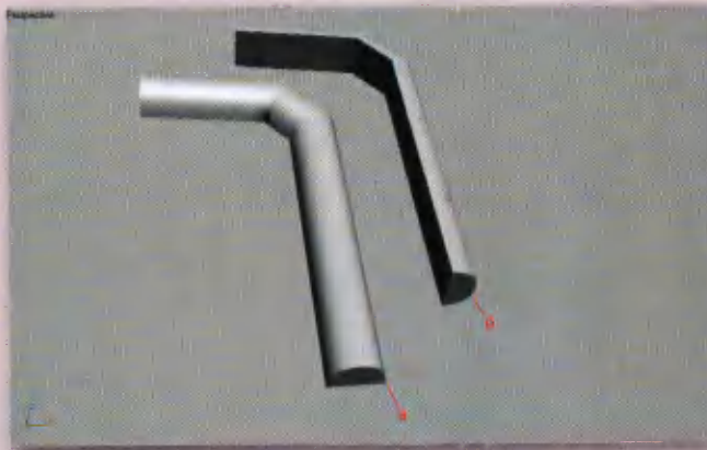
Рис. 5 Лофтинг-объект до поворота сечения (а) и после его поворота на 90° (б).
